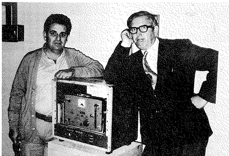
Hier ist er, der nimmermüde Sender: Heath DX40 modifiziert, 40 W Input, 12 W Output, 28.180 MHz, FSK 690 Hz shift. Die Anlage ist täglich 24 Std in Betrieb und befindet sich in einem Nebengebäude der BBC Station. Rolands Kopf verdeckt die Konzessionsurkunde der zypr. Behörde.
