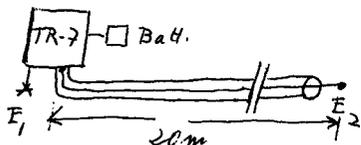
Daran angeschlossen sind 2 Erdsonden  $E_1$  und  $E_2$  aus 30 cm langen Messingstäben 4 mm  $\phi$ .  $E_1$  direkt unter dem Empfänger  $E_2$  über den Innenleiter eines 20 m langen Koaxkabel mit dem Ant. Eingang verbunden. Die Abschirmung des Kabels, das auf dem Boden liegt, ist mit dem Empf. Chassis verbunden. Dadurch wird eine Einstrahlung von oben verhindert. Wir haben nun  $E_2$  jeweils
