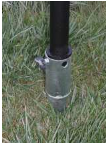
Abbildung 4: Bodendübel mit Hülse und eingesetzter Fischrute
