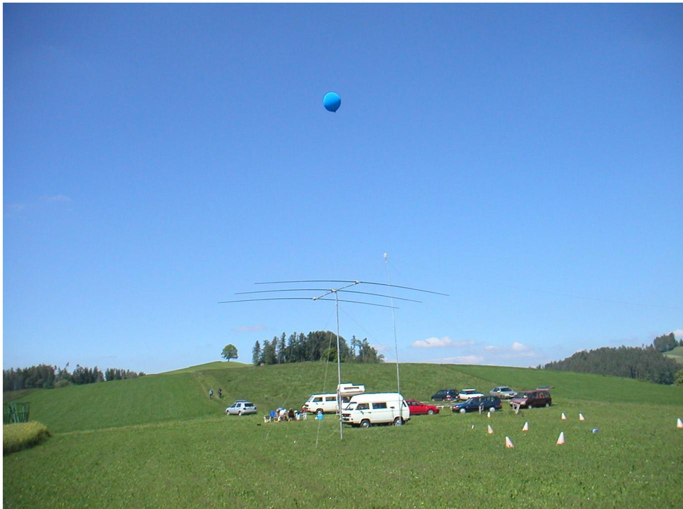
Abbildung 1: Standort Field Day 2004 oberhalb Utzigen. Gut sichtbar der Helium-Ballon, welcher den vertikalen Strahler der Groundplane-Antenne in die Luft hebt.
