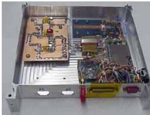
Abbildung 2: 2.4 GHz Digital Downlink Transmitter
