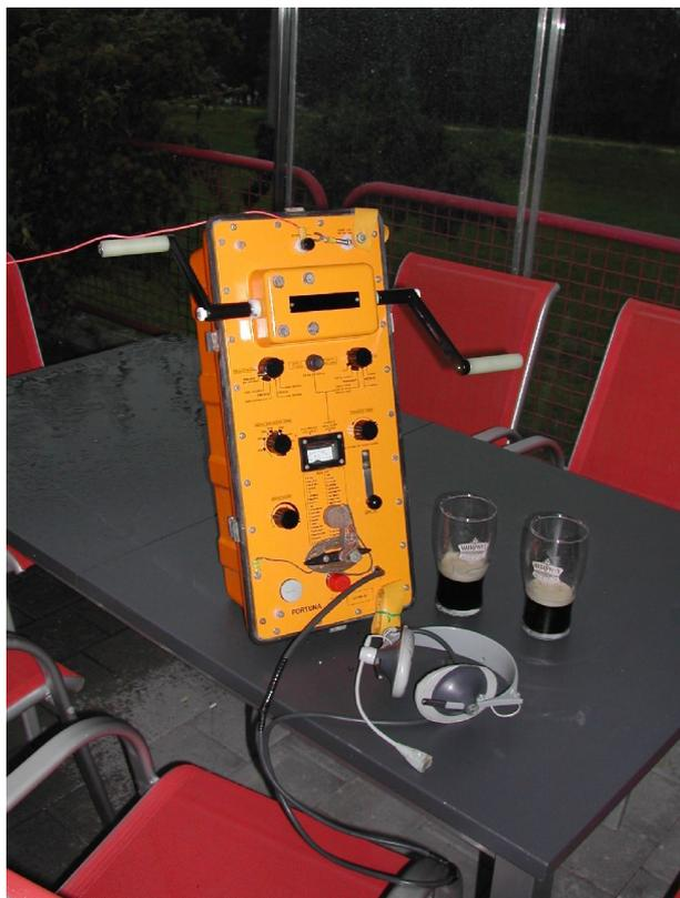
Abbildung 3: Seenotsender mit gut sichtbaren Handkurbeln an beiden Seiten
