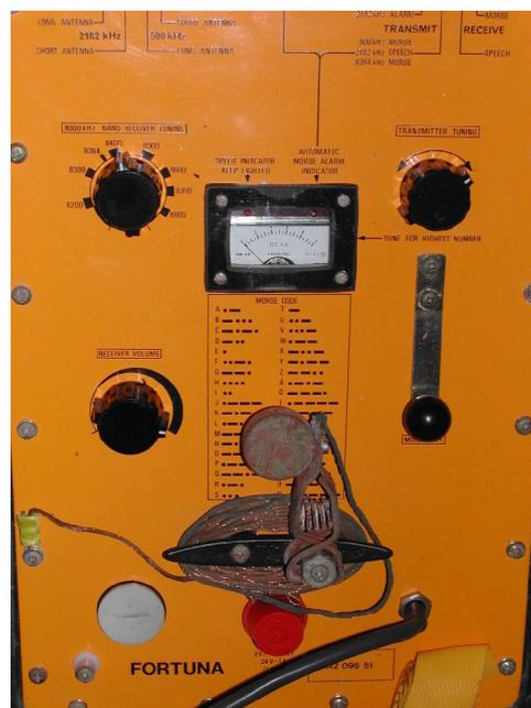
Abbildung 4: Frontplatte mit Bedienungselementen, Morsecode und -taster
