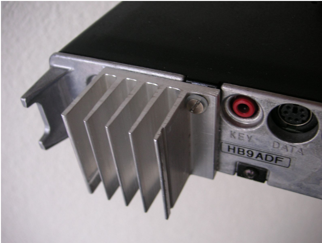
Abbildung 2: Der nach aussen geführte Kühlkörper der verbesserten Kühlung eines FT-817 Transceivers von Yaesu
