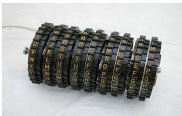
Abbildung 1: Rotorpaket der Nema
