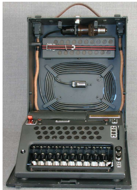
Abbildung 4: Chiffriermaschine Nema Modell 45. Maschine mit geöffnetem Kasten. Im Kastendeckel befindet sich ein zweites Lampenfeld.
