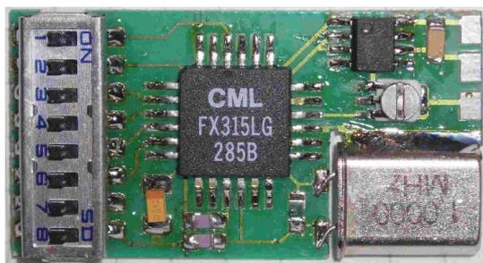
Abbildung 3: Schaltung des CTCSS Tongenerators. Gut sichtbar der CTCSS Encoder IC FX315LG
