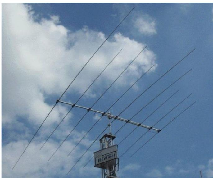
Abbildung 2: OptiBeam OB 9-5 für die Bänder 20, 17, 15, 12 und 10 Meter
