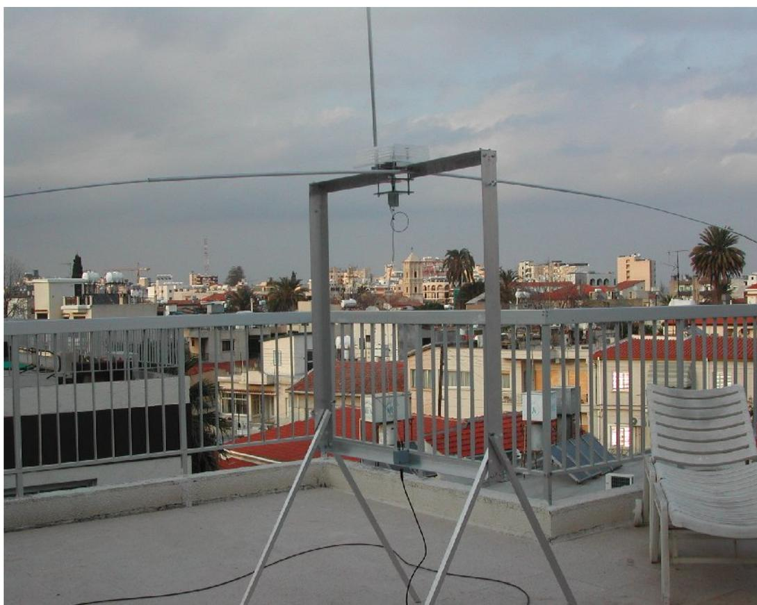
Benutzt habe ich nur die Bänder 17, 20 und 30m, die beiden höherfrequenten mit der Magnetloop und das 30m Band abwechslungsweise mit Magnetloop und Dipol. Ohne Vergleiche mit andern Antennen angestellt zu haben kann ich sagen, dass die Magnetloop auf den oberen Bändern sehr gut arbeitete. Erhielt ich doch damit auf 20m auf einen CQ-Ruf von einer 4S7 Station Antwort, und auch Pirmin unter 6W/HB9DTE nahm ich sofort auf. Und das mit QRP.
