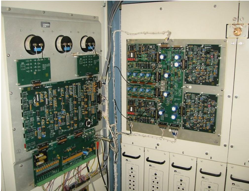
Der moderne Reservesender in Halbleitertechnik mit modularen Endstufen macht eher einen bescheidenen Eindruck, verglichen mit den älteren Röhrensendern
