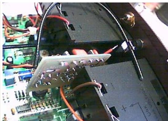
Die Mischerplatte zwischen den beiden Batteriekästen des Lowe HF-150
