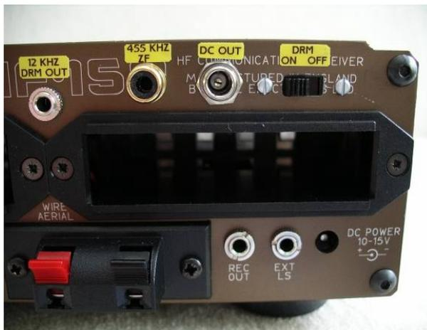
12 Khz – DRM-Ausgang und Ein- Ausschalter für die Mischerplatine
