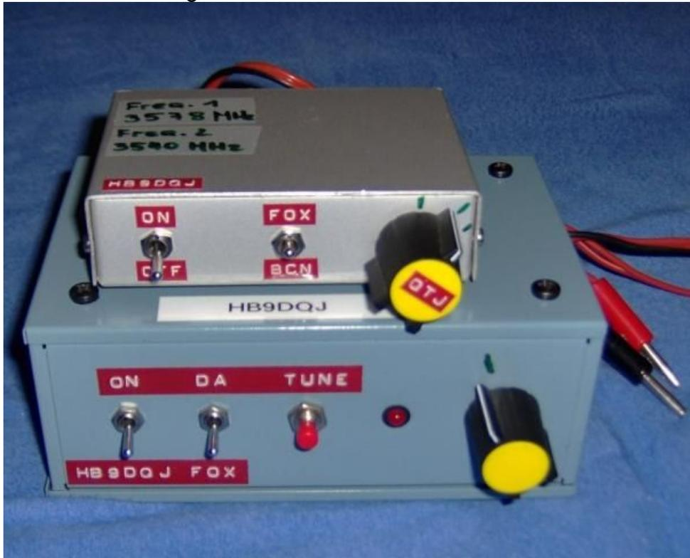
Eigenbau ARDF Fuchs und Bakensender für 80 Meter. Der Sender macht bei 13.8V 2.5 Watt Power. Oben auf dem Sender ist der Geber zu erkennen
