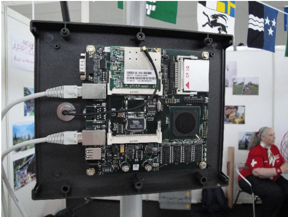
Abbildung 6: Ein APRS Gateway mit einem Einplatinen-Computer vom Typ Alix ( www.pcengines.ch )
