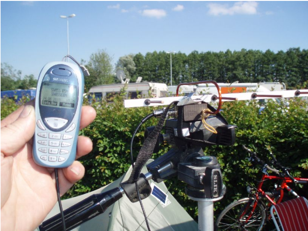
Abbildung 4: Man telefonierte mit dem heimischen Telefonnetz mit einer Richtantenne über den Bodensee (Antennen von Markus HB9TJX)
