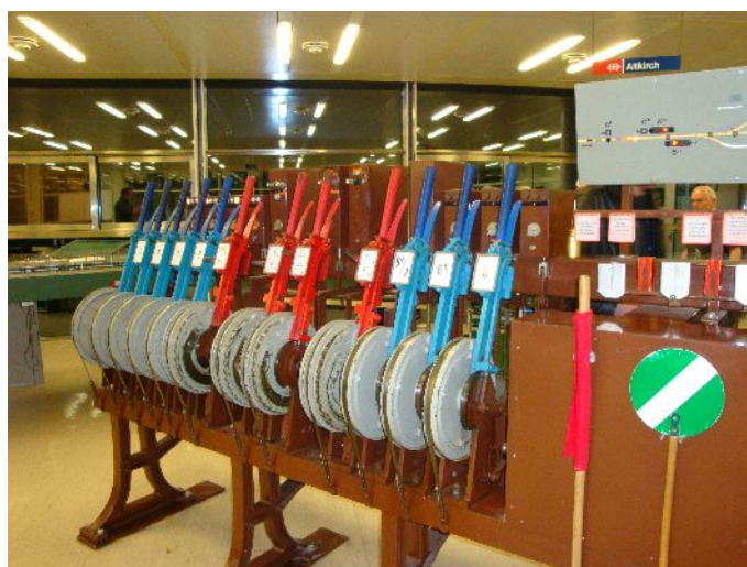
Abbildung 3: Stellwerk damals - Weichen und Signale
