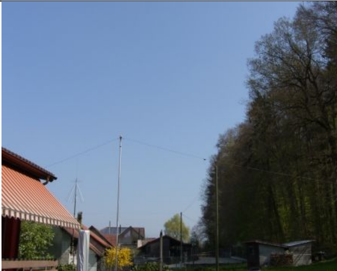
Abbildung 10: Die Inverted Vee für die oberen Bänder
