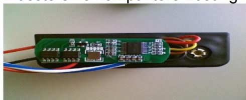
Als Ladeschaltung habe ich eine fertige Schaltung gefunden, welche als Li-Ion Akku-Überwachungsschaltung für drei Zellen gedacht ist (Fr. 6.60). Diese ist sehr klein und passt mit doppelseitigem Klebeband an die Stirnseite des Batteriehalters. Die Platine ist mit jeder Zelle verbunden: auf dem Bild die Drähte rechts; schwarz minus, braun erste
