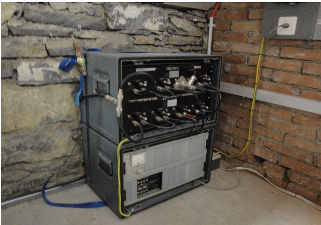
Abbildung 2: Das Relais ist ein kompakter Block. Oben die Eingangsseite mit den Filtern, darunter die Ausgangsseite mit den entsprechenden Filtern. Ganz unten die TRX.
