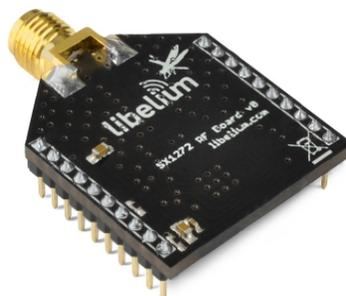
Abbildung 3: Ein LoRa Modul mit dem Semtech SX1272 Chip
