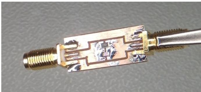
Die Grösse ist ca. 10x25mm. Bestückt wurde mit einem SMD Widerstand 2.2k der Grösse 1206 und einem Keramikcondensator 33pf der Grösse 0805. Die Anschlüsse habe ich mit SMA Platinenrand-Buchsen realisiert.
