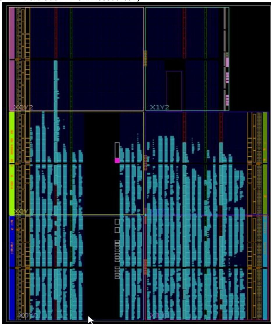
Abb. 2) FPGA nutzung KiwiSDR DDC
