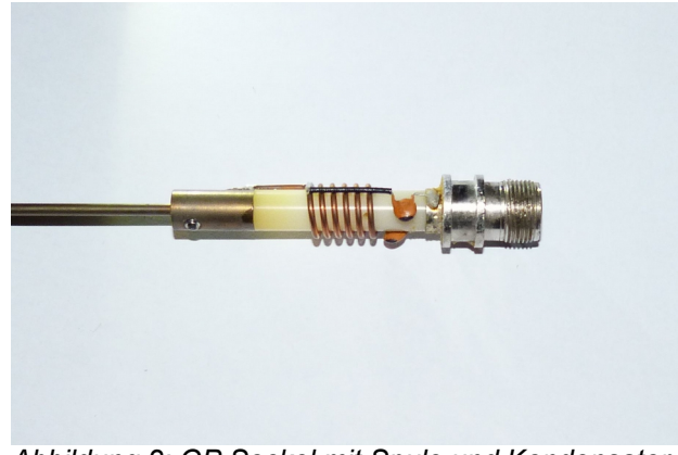
Abbildung 2: GP Sockel mit Spule und Kondensator
