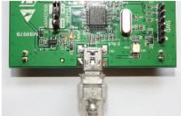
*Bild 20: Anschluss zum Flashen*
