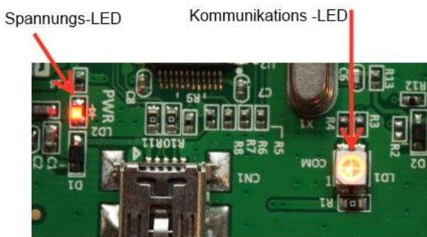
Bild 9: Power- und Kommunikation-LED
