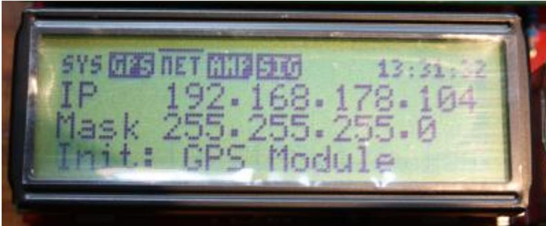
*Bild 10: Display LCD DIP 122*
